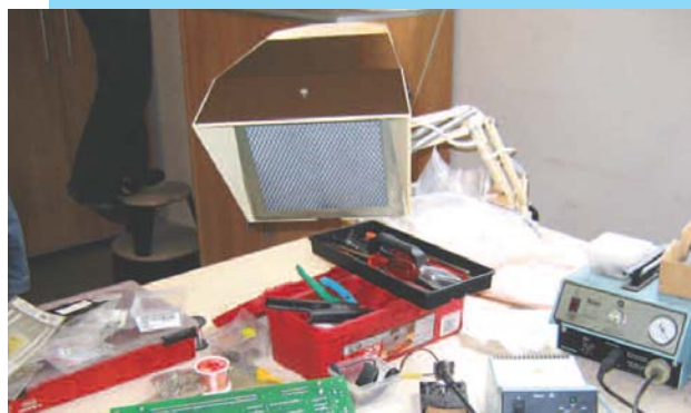
Mini-hotte de filtration HI8F avec bras articulé
