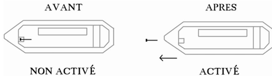
Déclencher Dometemp à température ambiante en enlevant la buté. Le positionner impérativement sur l'objet à contrôler au dessus de sa température de contrôle à plat ou verticalement en faisant attention aux manipulations trop brusque.
