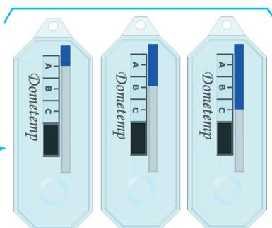
Il enregistre de façon irréversible le cumul de rupture de la chaîne du froid
